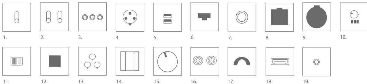
1. Simple bouton ; 2. Double boutons ; 3. Triple Boutons (Rond uniquement) ; 4. Prise de courant ; 5. USB ; 6. RJ45 ; 7. TV ; 8. Prise de sol ; 9. Prise à clapet IP44 ; 10. Thermostat rotatif ou digital ; 11. Sortie de fil ; 12. Obturateur ; 13. Satellite ; 14. Lecteur de carte ; 15. Variateur rotatif ; 16. Haut parleur ; 17. Detecteur de mouvement ; 18. HDMI ; 19. Prise jack
