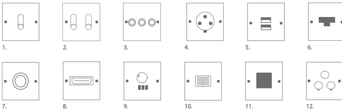
1. Simple bouton ; 2. Double boutons ; 3. Triple boutons (Rond uniquement) ; 4. Prise de courant ; 5. USB ; 6.RJ45 ; 7.TV ; 8. HDMI ; 9. Thermostat rotatif ou digital ; 10. Sortie de fil ; 11. Obturateur ; 12. Satellite
